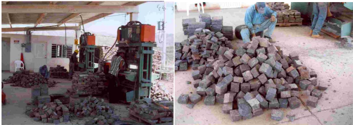
A la derecha se muestra dos de las tres cortadoras hidráulicas del Grupo Empresarial de Laja Los Charcos; a la derecha el producto terminado principalmente el denominado cubo.
